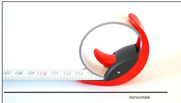
Abbildung 3.4-3: Versuchsnummer 1, Ablesen der Ausfahrlänge
